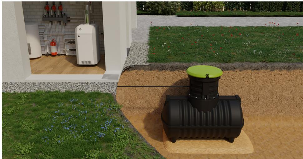
Конструкция емкости рассчитана на неравномерное поступление дизельного топлива. Емкость рассчитана на подключение к котлу, расположенному в помещении. Для подключения емкости к котлу предусмотрены втулки всасывающей и обратной линии, изготовленные из металлопласта. Забор топлива происходит с помощью насоса, установленного в котле. Емкости предназначены исключительно для подземного монтажа.
